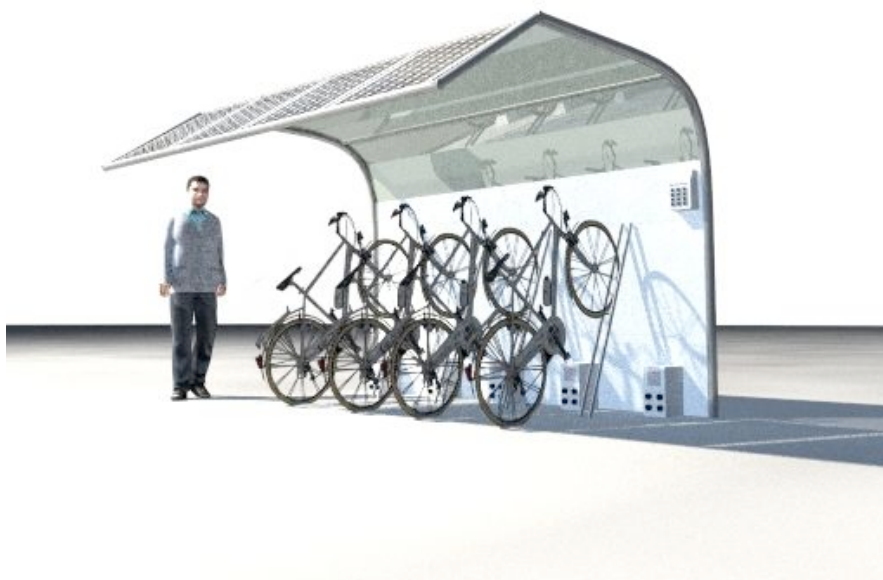
Figura 1 – Stazione di ricarica fotovoltaica, per biciclette elettriche, a pianta rettangolare.
