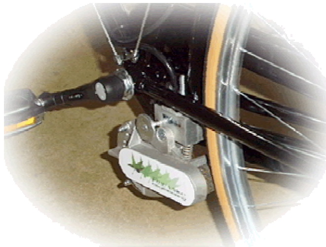
Figura 4 – Il Motorino elettrico è accoppiato alla ruota posteriore e fissato nel foro del cavalletto.
